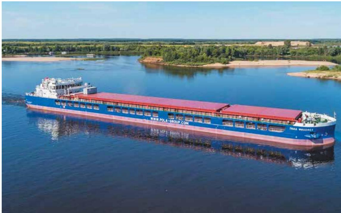
плуатации судов первой серии. Увеличение грузоподъемности сухогруза в море стало возможным благодаря увеличению осадки и конструктивным изменениям носовой части судна.
