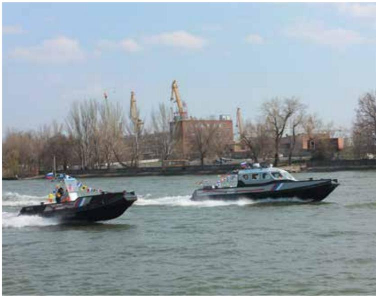
Судостроительно-судоремонтный завод «Риф» (входит в группу компаний «Ростовский порт») представил два маломерных судна «Риф-75» и «Риф-112», построенных по новой технологии из полиэтилена высокой плотности в Ростове-на-Дону. В акватории реки Дон 14 апреля два новых катера продемонстрировали свои тактико-технические характеристики.
