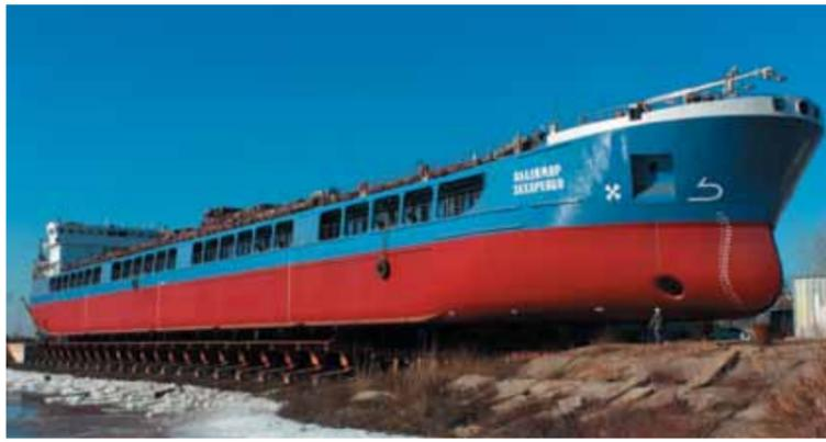
наибольший дедвейт в море при осадке 4,7 м — 7150 тонн. Длина наибольшая — 139,95 м, ширина габаритная — 16,7 м, ширина без учета привальных брусев — 16,5 м, высота борта — 6 м. Вместимость грузовых трюмов 10 920 куб. м.
