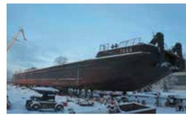
буксирно-кантовочных работ с несамоходными сухогрузными и наливными судами на акваториях портов, заводов, в шлюзах, а также с плотами в шлюзах и на переформировочных рейдах. Ему предстоит ремонт рулевого устройства, валопроводов, движителей, донно-заборной арматуры, дефектация и ремонт корпуса судна.
