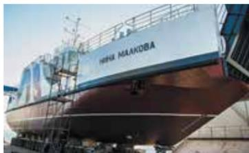
«Керченская морская верфь «Фрегат» спустила на воду автомобильный грузопассажирский паром ледового класса для эксплуатации на внутренних водных путях РФ. Грузоподъемность судна, получившего имя «Нина Малкова», построенного по проекту ОАО «Инженерный центр судостроения» (Санкт-Петербург) составляет 80 тонн, паром рассчитан на 4 автопоезда или 16 легковых автомобилей.
