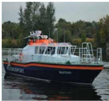
Катер, оснащенный ходовой системой Volvo Penta IPS 450 (добавляющей до 20% к максимальной скорости и 15% к скорости разгона), получил за свою стремительность имя «Марлин». Это современное, мощное, экономичное, быстроходное и высокоманевренное судно, представляющее собой синтез современных конструкторско-дизайнерских решений и инновационных технологий.
