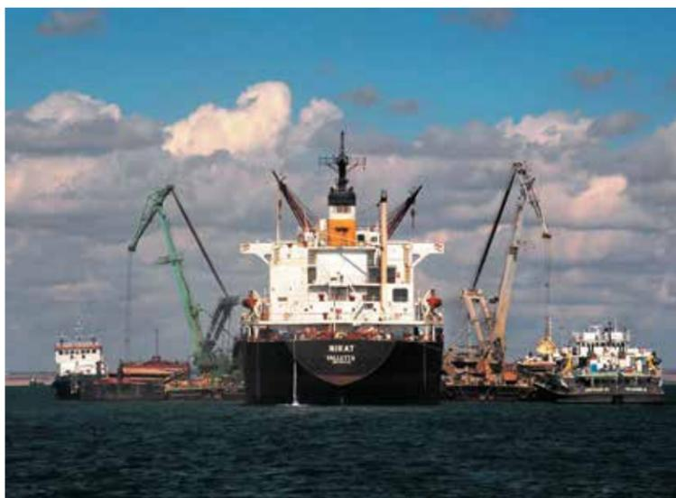
на балкеры осуществляют самоходные плавучие краны GANZ грузоподъемностью 16 тонн, в
